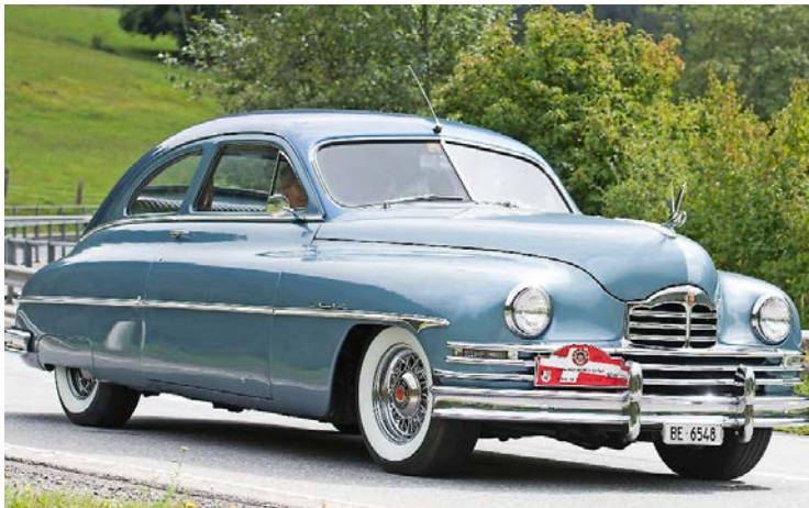
Der Packard Clipper mit in der Karosserie integrierten Kotflügeln und Kofferraum.
