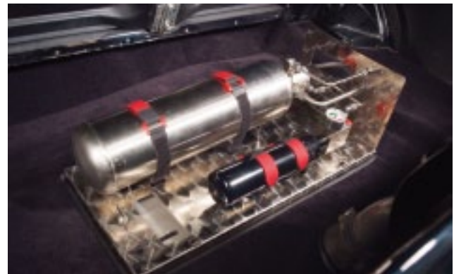
In der geöffneten Anlage zeigen sich Kontrollkreislauf und der Behälter der Löschflüssigkeit.
